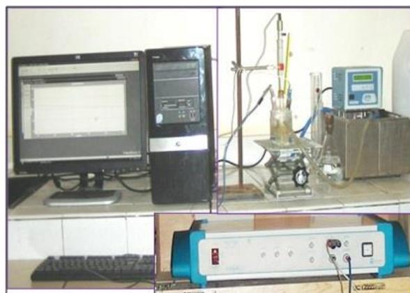
**Figure 1.** Potentiostat VoltaLab 301-1.
